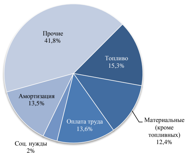
Рисунок 4.5 Структура затрат 19 на производство электрической энергии атомными электростанциями в 2013 г. в целом по Российской Федерации
