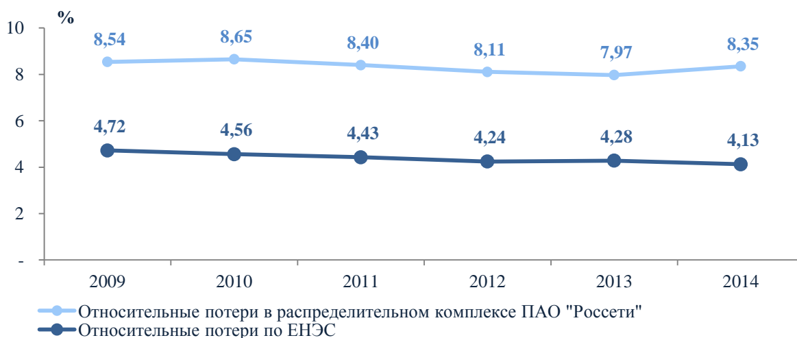
Рисунок 1.20 – Динамика относительных потерь электроэнергии в магистральном и распределительном комплексах компании ПАО «Россети» 10
